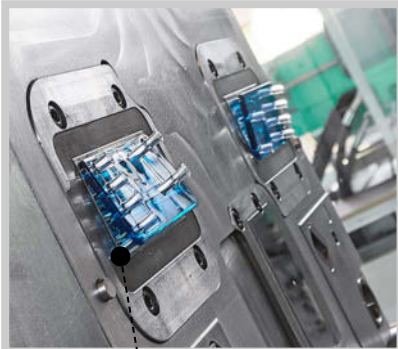
Lab-on-a-Chip „ready-to-use“: komplexes Montagespritzgießen mit zwei Komponenten.
