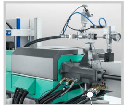
Proceso seguro: el módulo de cilindro atemperado por líquido evita una reticulación prematura.
