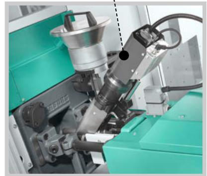
Flexible: el módulo de microinyección puede sustituirse fácilmente por un módulo de cilindro estándar.
