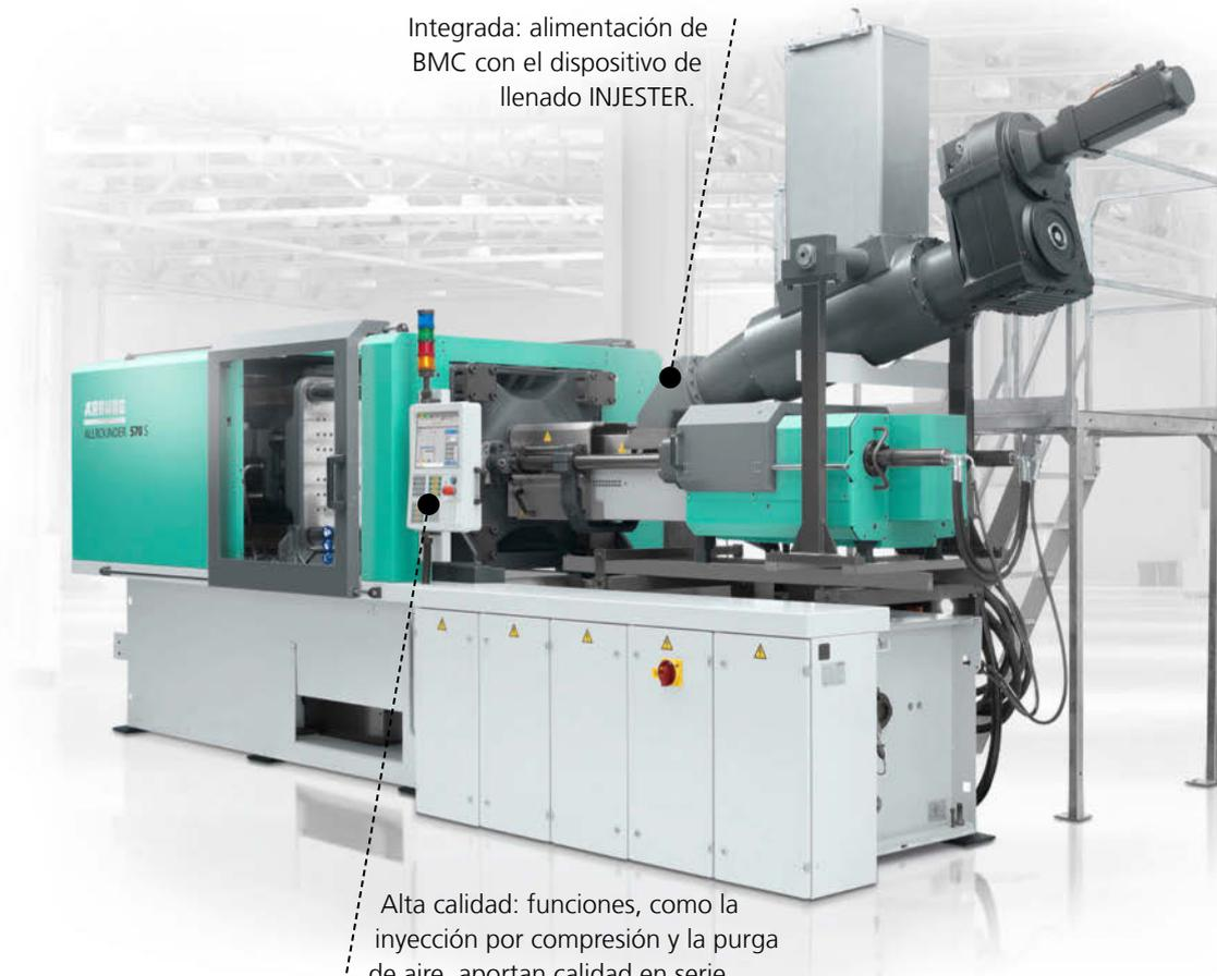
Integrada: alimentación de BMC con el dispositivo de llenado INJESTER.
