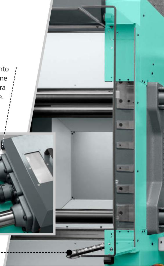
Unità di iniezione orientabile: la vite può essere serrata senza smontare il modulo cilindro
