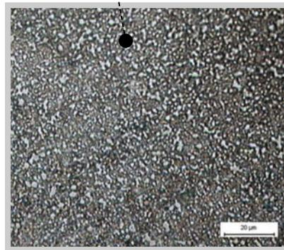
Con resistencia al desgaste: estructura del carburo en acero metalúrgico de fusión.
