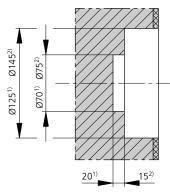
Unidad de inyección 800¹) y 1300²) en ejecución para termoestables -Unidad de inyección 2100 a petición
