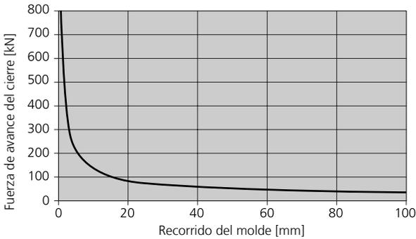
\* ajuste automático de la fuerza de cierre hasta 20 kN
