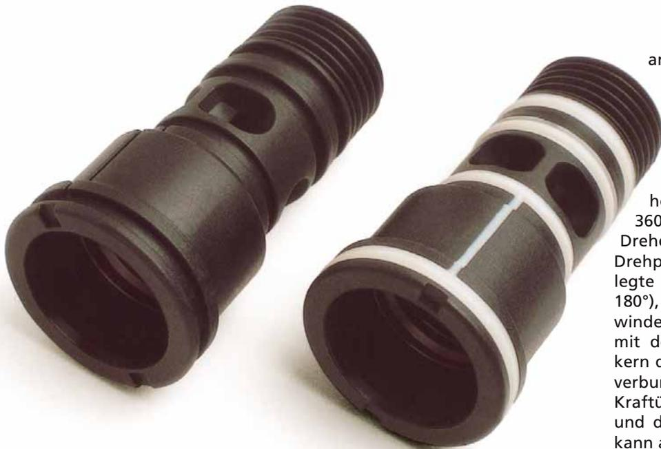
Dreheinheit des Werkzeugs stammt von ARBURG und arbeitet mit Festanschlägen. Die Ausschraubeinheit „F“ wird eingesetzt, um das Innengewinde zu entformen. Das Heißkanalsystem stammt von Männer. Das Material des Grundkörpers ist PA, die Dichtungen bestehen aus TPE. Die Konfiguration wird durch Thermolift 100-2 Trocken- und Fördergeräte komplettiert.
