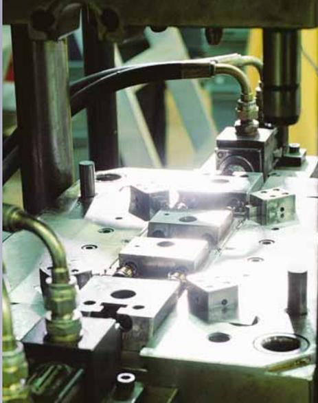
Am Standort Casale werden auf Vertikalmaschinen verschiedenste Spulen mit Kunststoff umspritzt. Fotos: Eltek
