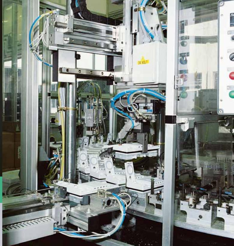
Dosiereinheiten von Geschirrspülern werden vollautomatisch montiert. Nach dem Spritzgießprozess folgt das Zusammenfügen zu einbaufertigen Gesamtkomponenten.
