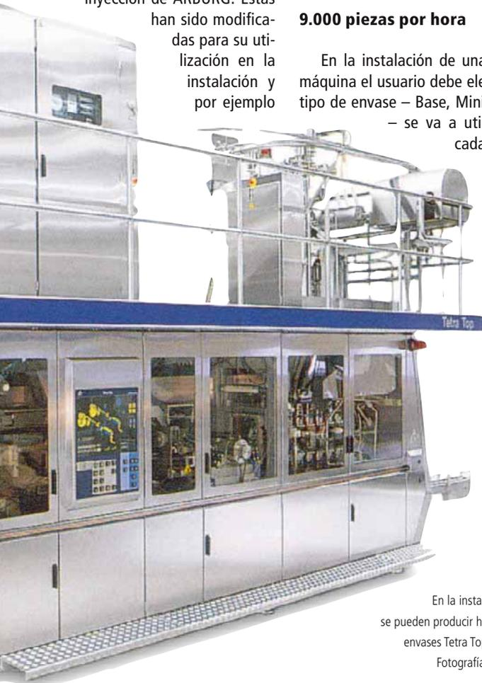
En la instalación TT/3 se pueden producir hasta 9.000 envases Tetra Top por hora. Fotografía: Tetra Pak
