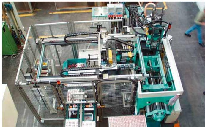
Adecuado a las necesidades: Una ALLROUNDER 420 C para la transformación de tres componentes integrada en una celda de producción para la fabricación de pistones de cilindro.
