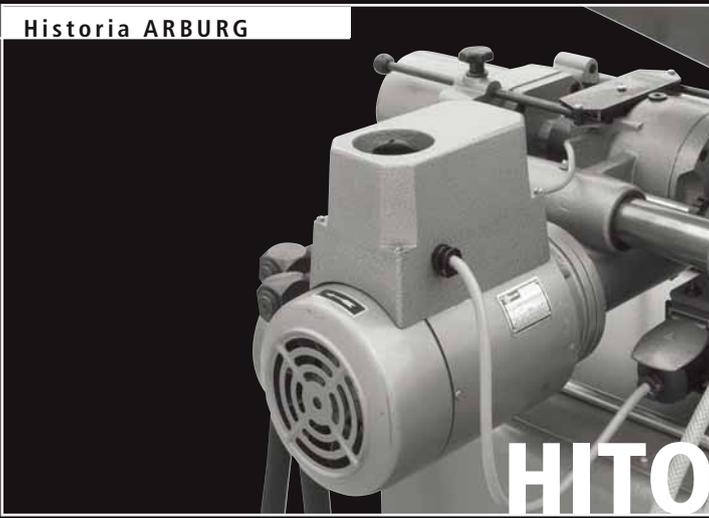
**L**a dosificación electromecánica, un hito en ARBURG? Más de uno se preguntará que esto está solamente desde el año 1997. Por tanto, ya desde principios de los años 60, existía un dispositivo de dosificación con motor eléctrico en las ALLROUNDER 200, las primeras máquinas de inyección ARBURG en ejecución de husillo.
