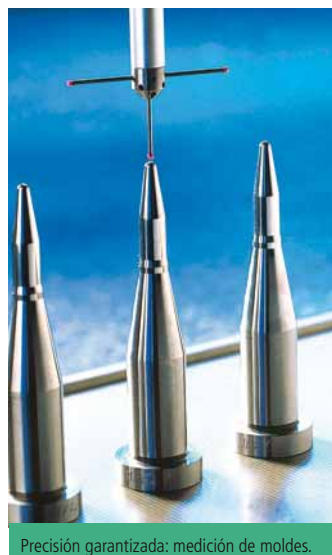
Precisión garantizada: medición de moldes.
