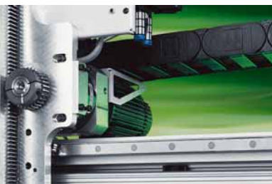
Accionamiento servoeléctrico: rápido y preciso
