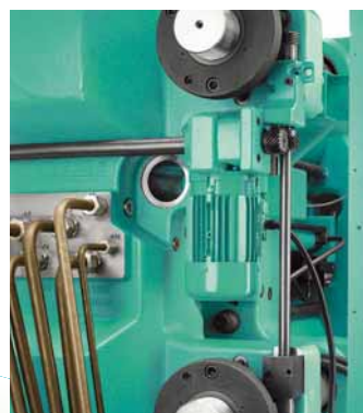
Detalle interesante de las grandes: Unidad de accionamiento del ajuste de la altura del molde.
