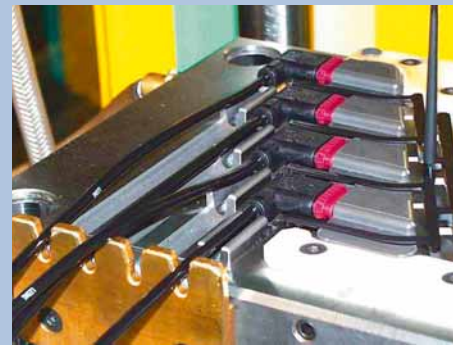
Sobreinyección de conexiones ABS.
