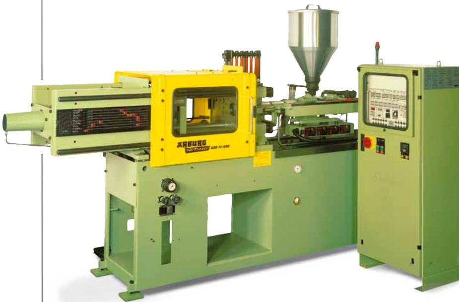
im damaligen Maschinenprospekt heißt: „Wesentlicher Fortschritt gegenüber konventionellen elektronischen Steuerungen ist die Verwendung eines Mikrocomputersystems ... , das eine Vielzahl von Leitungszügen und diskreten Bauelementen (Hardware) durch entsprechende Programmierung von Halbleiterspeichern (Software) ersetzt“. Damit standen Einrichtern und Bedienern von nun an mehrere Programmvarianten zur Verfügung, wo es bislang nur
