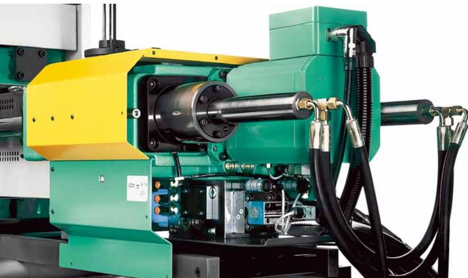
Hohe Dosiergenauigkeit und geringerer Energieverbrauch garantiert der elektrische Direktdosierantrieb. In Verbindung mit einer Nadelverschlussdüse lassen sich darüber hinaus ein großes Dosierzeitfenster und gleichzeitig ablaufenden Maschinenbewegungen realisieren. Die daraus resultierende Zykluszeitreduktion reicht bis in den Sekundenbereich. Scherempfindliche Materialien können schonender aufbereitet werden. Durch die Ausstattung mit AES wird in den einzelnen Phasen des
