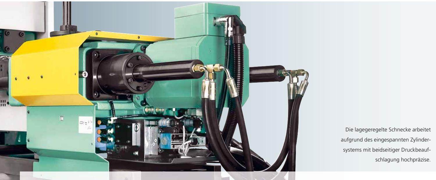
Die lagegeregelte Schnecke arbeitet aufgrund des eingespannten Zylindersystems mit beidseitiger Druckbeaufschlagung hochpräzise.
