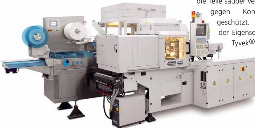
Die komplette Reinraumzelle (unten) integriert einen ALLROUNDER 270 U und ein MULTILIFT H zur Teileentnahme und -ablage (Mitte) aus dem ARBURG Programm sowie eine Verpackungsmaschine (oben l.) und einen Materialtrockner und -förderer (oben r.) externer Lieferanten.
