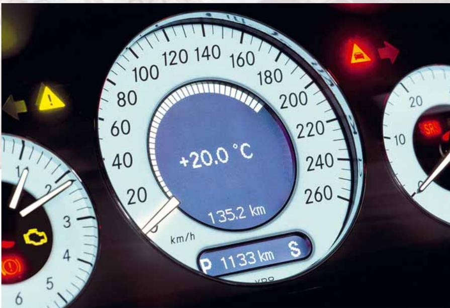
**D**amit Rundinstrumente und andere analoge Anzeigen in PKW und LKW auch exakte Informationen an die Fahrer liefern, sind so genannte Schrittmotoren vorgeschaltet, die die abgenommenen Informationen über Zahn- und Schneckenräder in möglichst genaue Zeigerbewegungen umsetzen. Bei Siemens VDO Automotive im hessischen Babenhausen werden die Gehäuse der Schrittmotoren auf ALLROUNDER Produktionszellen hergestellt.
