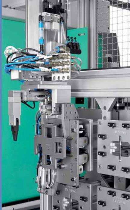
Bild Mitte: Die Produktionsanlage besteht aus dem ALLROUNDER 320 C, dem MULTILIFT V sowie dem angeschlossenen Ablagesystem. Bild oben Mitte: Der Greifer des Entnahme-Robots fährt zur Prüfung der vollständigen Teileentnahme sowie zur Abfrage der Formnester vor das Kamerasystem. Bild oben rechts: Der Greifer des MULTILIFT Robotersystems bei der Übergabe der Fertigteile an das Ablagesystem.
