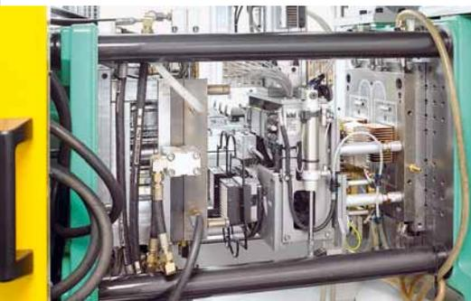
planteaba exigencias considerables al sistema de robot y a los periféricos. Los perfiles para junta flexibles de HNBR presentan tolerancias de producción, se deben desmoldar en las estaciones de puesta a disposición, el agarre los debe recoger de manera segura para finalmente introducirlos en el molde. Los papeles del filtro se deben suministrar doblados, el agarre los tiene que fijar sin dañarlos y situarlos
