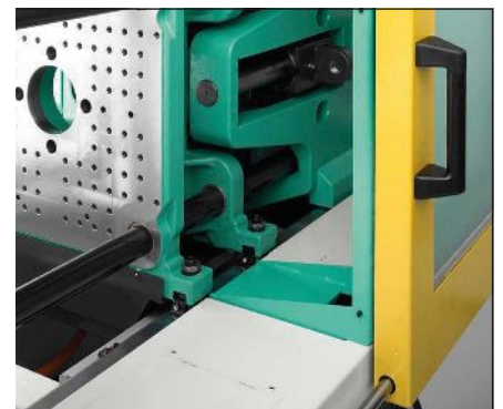
Oben: Mehr Platz bietet die zur Rückseite vergrößerte Schutzhaube.
