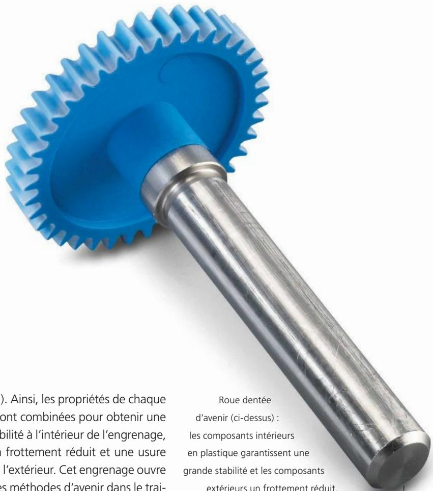
Roue dentée d'avenir (ci-dessus) : les composants intérieurs en plastique garantissent une grande stabilité et les composants extérieurs un frottement réduit, permettant ainsi une usure minimale.
