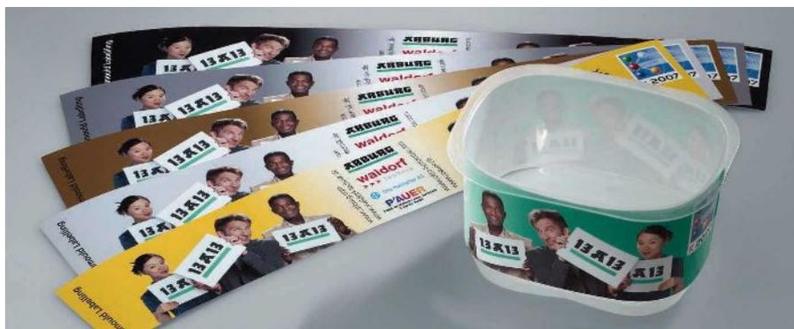
ARBURG présente également un projet IML (Inmould Labelling) à la K 2007, pour lequel il s'agit de combiner rapidité et précision. Un moule à six cavités permet de fabriquer des pots de yaourts dotés d'étiquettes avec des avantages économiques exceptionnels. L'ensemble de l'automatisation nécessaire a été conçu autour d'une ALLROUNDER 570 A, qui représente actuellement, avec sa force de fermeture de 2000 kN et son unité d'injection 800, la plus grande presse électrique de la gamme ARBURG.
