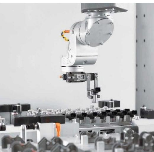
différents, trois moules à huit cavités ont également été développés. Peuvent être fabriqués des inserts avec tête de connecteur 0°, à la verticale dans le moule, ainsi que des inserts avec tête de connecteur coudée à 12°, à l'horizontale dans le moule et inserts avec tête de connecteur coudée à 30°, également à l'horizontale dans le moule. Les véhicules équipés de moteurs à gicleurs de pompes ainsi que de l'injection common rail peuvent en être équipés.
