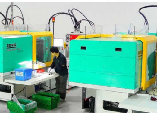
Pour la fabrication de produit LSR, Hopeful Rubber utilise aujourd'hui neuf ALLROUNDER hydrauliques avec des forces de fermeture allant de 500 à 1.300 kN et des moules à canal froid que l'entreprise fabrique elle-même.
