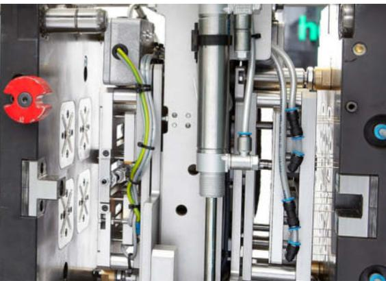
Le système de préhension positionne les broches filigranes avec précision dans le moule et prélève les broches surmoulées finies (photos du haut).
