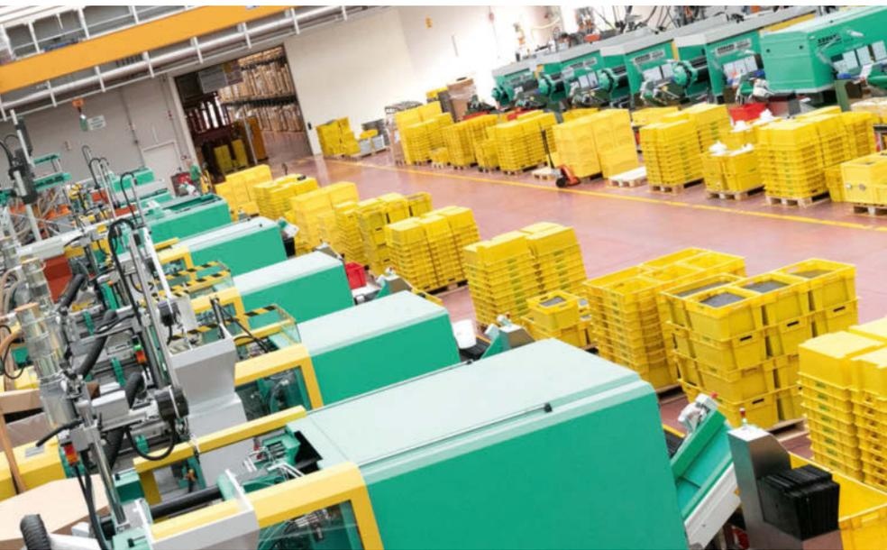
interior de PA12 TR55 se produce con una ALLROUNDER 420 C advance, mientras que la pieza exterior con rosca de PPO G30 la realiza una ALLROUNDER 520 C advance. Ambas máquinas trabajan con moldes de dos cavidades con sistema de canal caliente y boquillas con aguja de cierre para la inyección sin colada.
