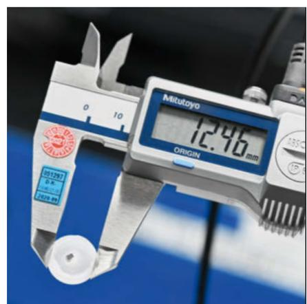
Le nano-capteur filigrane, avec son aimant central, d'un diamètre de 12,5 millimètres (illustrations ci-dessus) est fabriqué sur une installation clés en main sur laquelle les chargeurs d'aimants sont équipés à la main (illustration à gauche).
