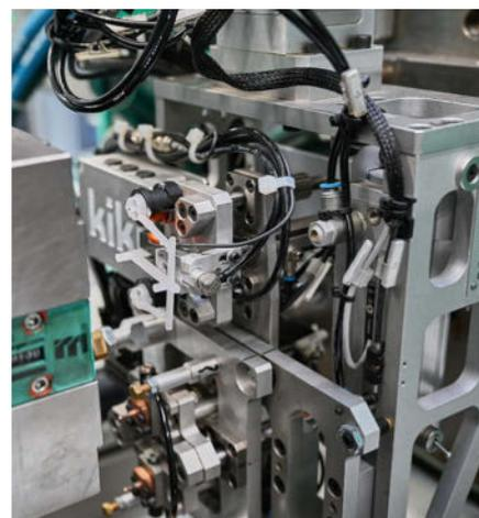
Dans l'installation clés en main (illustration à gauche), le préhenseur met d'abord les aimants en place dans l'outil puis prélève les pièces injectées et la carotte (illustration ci-dessus).
