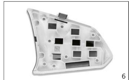
Für die Herstellung der Lenkradschaltfläche (großes Bild links) sind acht Arbeitsschritte erforderlich. Die Zwischenprodukte (kleine Bilder) sind jederzeit identifizierbar. Angefangen vom Siebdruck der Folie (1) und Hochdruckformen (2) über das Aushärten und Stanzen (3) Hinter-spritzen (4), Verkleben der Sensorfolie (5) und Ultraschallschweißen bis zum fertigen Teil (6).
