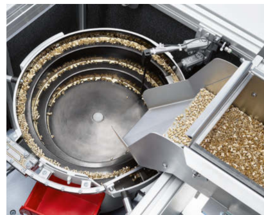
Estaciones de la producción automatizada: robot de montaje KUKA y sistema de robot MULTILIFT (foto sup. izda.), alimentador vibratorio para la alimentación de las hembras (foto sup. dcha.), depósito separado por cavidades (foto inf. izda.), así como extracción de las piezas moldeadas y carga del molde (foto inf. dcha.).
